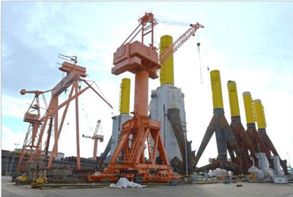
Fundamente für Offshore-Windkraftanlagen auf dem Gelände der Siag Nordseewerke Emden. Die Stahlturme werden, nachdem sie in den Meeresboden gerammt wurden, nur provisorisch beleuchtet. "Mein Schreckensszenario ist, dass da mal ein Schiff reinkracht", sagt der Leiter des Referats Ordnung des Meeres, Christian Danke.
