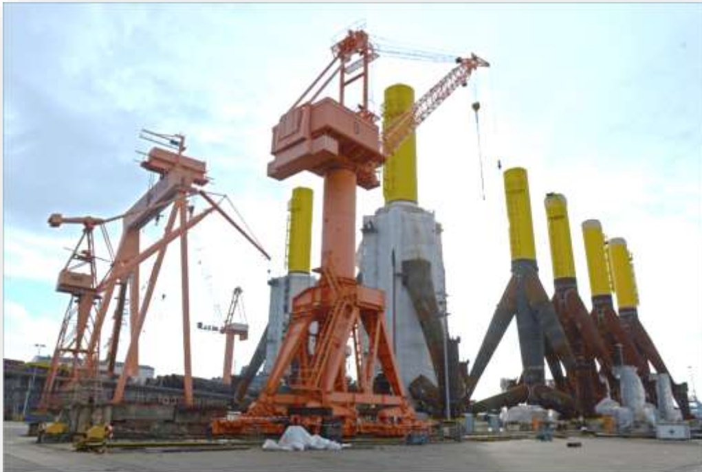
Fundamente für Offshore-Windkraftanlagen auf dem Gelände der Siag Nordseewerke Emden. Die Stahltumpen werden, nachdem sie in den Meeresboden gerammt wurden, nur provisorisch beleuchtet. Mein Schreckensszenario ist, dass da mal ein Schiff reinkracht, sagt der Leiter des Referats Ordnung des Meeres, Christian Dahlke.
